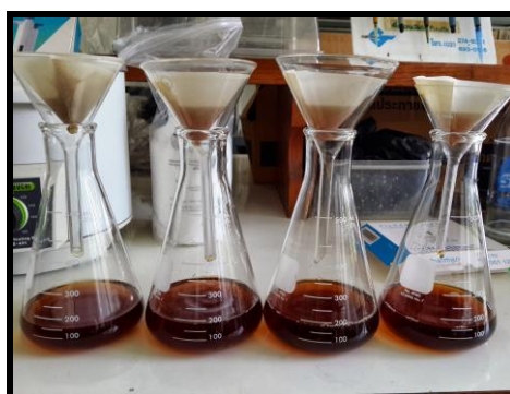
ภาพที่ 8 กรองน้ำส้มควันไม้ด้วยกระดาษกรอง
