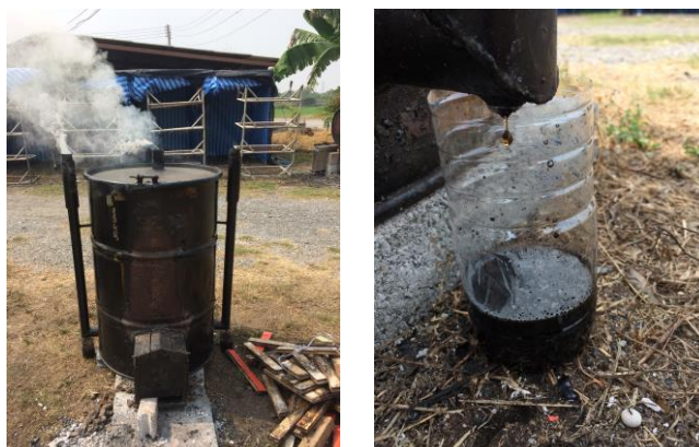
ภาพที่ 17 การหรี่หน้าเตาให้เหลือ 1 ใน 4 และการเก็บน้ำส้มควันไม้
