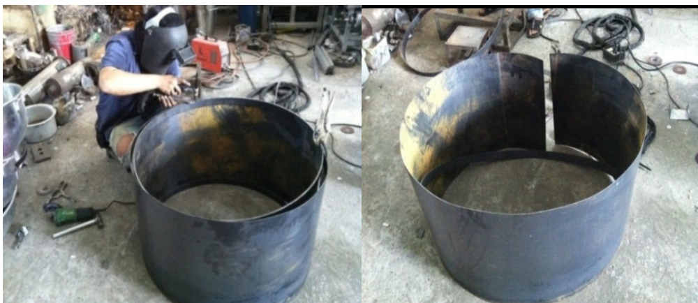
ภาพที่ 3.8 เชื่อมประกอบชุดบังลม
