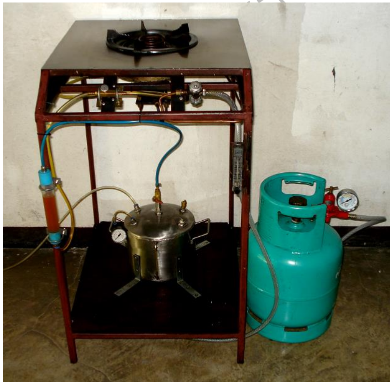
รูปที่ 3.3 ชุดอุ่นเชื้อเพลิงของหัวเผา น้ำมันพืชใช้แล้ว
