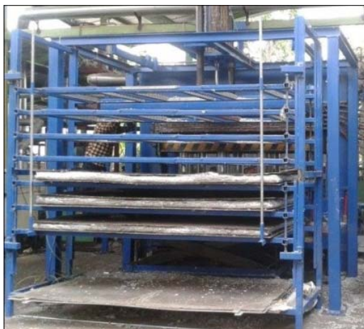
ภาพที่ 3.21 นำเข้าเครื่องอัดร้อนที่อุณหภูมิประมาณ 180^{\circ}\text{C}
