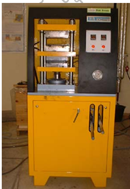
ภาพที่ 2.26 ลักษณะเครื่องอัดและการขึ้นรูปแบบกระบวนการอัด(Compress Molding)
