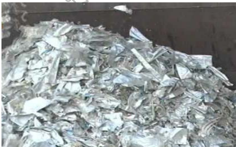
ภาพที่ 3.15 แผ่นวัสดุผสมอะลูมิเนียมฟอยล์กับพลาสติกที่ได้จากกล่อง UHT
