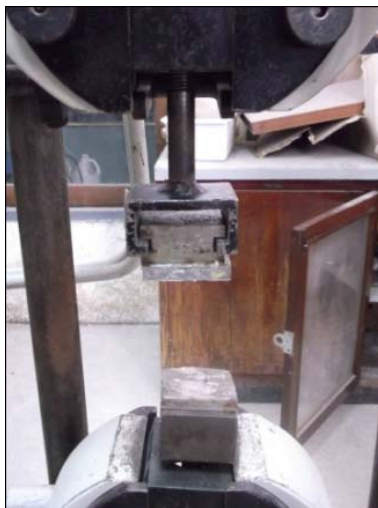
ภาพที่ 3.33 การแยกออกจากกันของชั้นทดสอบ
