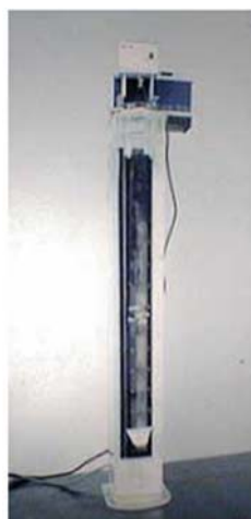
ภาพที่ 2.48 ตัวอย่างคอลัมน์สำหรับทดสอบแบบ Density Gradient Technique
