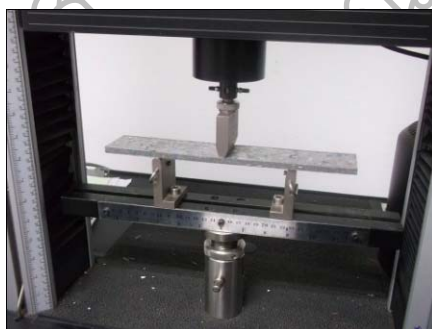
ภาพที่ 3.29 การติดตั้งชิ้นทดสอบ MOE และ MOR
