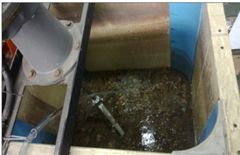
ภาพที่ 3.14 การปั่นกระดาษที่มาจากกล่องนมให้ละเอียด
