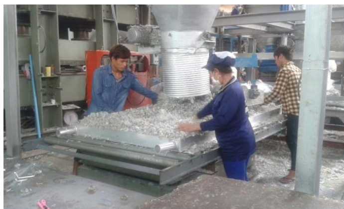
ภาพที่ 3.20 การวางวัสดุผสมที่ทำเป็นชิ้นเล็กๆแล้วบนแผ่นเหล็ก
