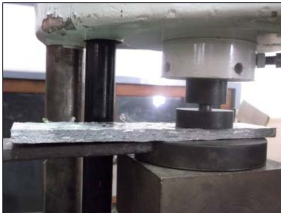
ภาพที่ 3.26 การทดสอบความแข็งของชิ้นงาน
