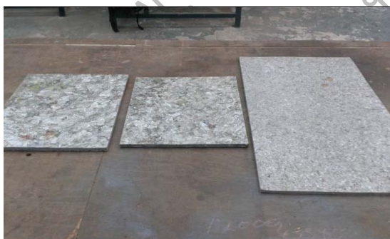
ภาพที่ 3.22 แผ่นชิ้นงานจากวัสดุผสม อลูมิเนียมฟอยล์กับพลาสติก
