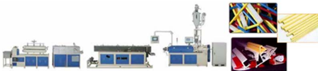
ภาพที่ 2.29 กระบวนการผลิตและผลิตภัณฑ์จากการขึ้นรูปแบบ Pipe/Tube/Profile Extrusion
