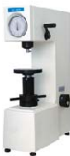
ภาพที่ 2.34 เครื่องทดสอบความแข็งแบบ Rockwell พร้อมหัวกด
