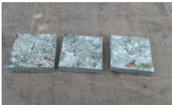
ภาพที่ 3.23 แผ่นชิ้นงานทดสอบ ขนาด 50 \times 50 \times 8 มม.
