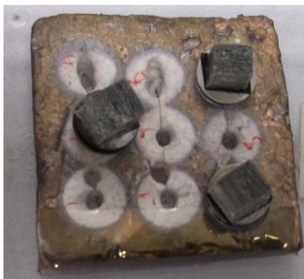
ภาพที่ 3.43 ติดชิ้นงานกับฐานรองรับชิ้นงาน
