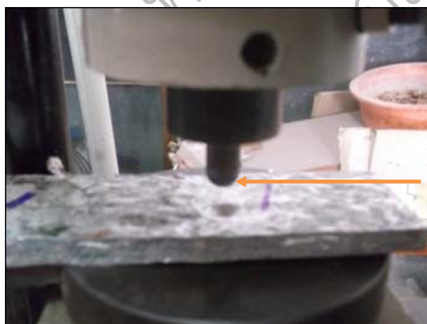
ภาพที่ 3.27 รอยกดจากการทดสอบความแข็ง
