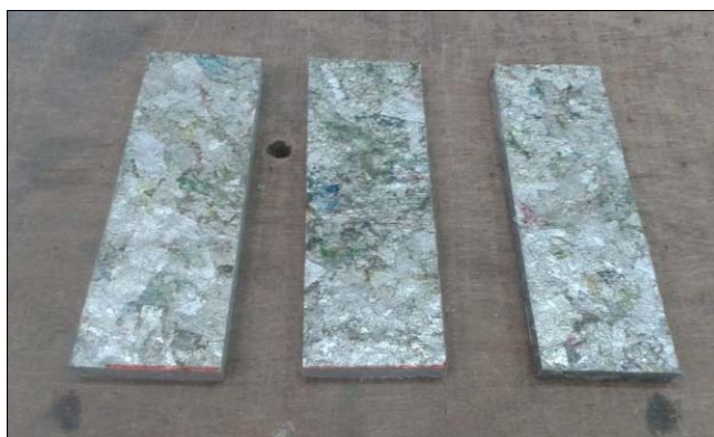
ภาพที่ 3.25 เตรียมชิ้นงานในการทดสอบความแข็ง
