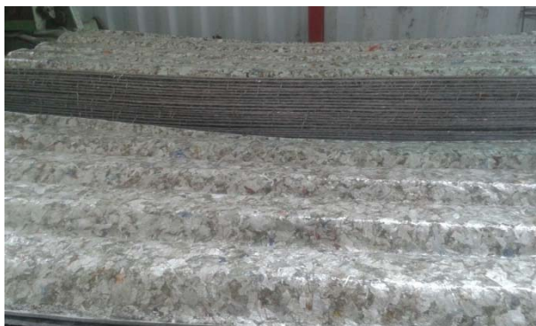
ภาพที่ 3.46 แผ่นหลังคาลอน ผลิตจากวัสดุผสมรีไซเคิล ประเภทกล่อง UHT
