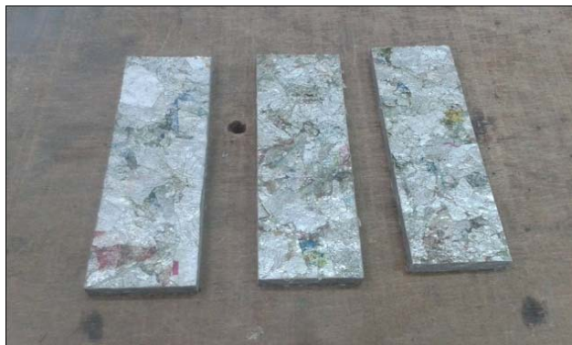
ภาพที่ 3.24 แผ่นชิ้นงานทดสอบ ขนาด 50 x 150x8 มม.
