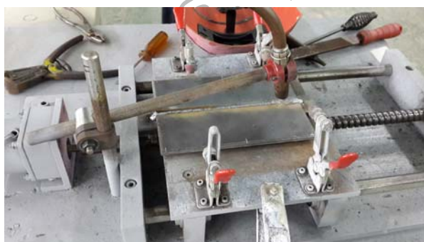
ภาพที่ 3.3 แสดงการเชื่อมชิ้นทดลองตามขนาด
