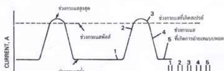
รูปที่ 3-3 การส่งถ่านน้ำโลหะแบบสเปรย์
