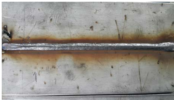
ภาพที่ 3.4 แสดงลักษณะขึ้นทอลงขนาด 5 มิลลิเมตร
