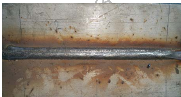
ภาพที่ 3.6 แสดงลักษณะขึ้นทอลงขนาด 10 มิลลิเมตร
