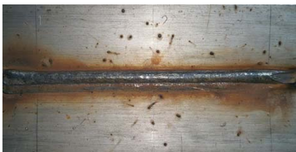
ภาพที่ 3.5 แสดงลักษณะขึ้นทอลงขนาด 7 มิลลิเมตร
