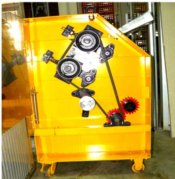
รูปที่ ก. 8 การติดตั้งชุดส่งกำลังแก่ลูกกลิ้งด้านซ้ายของเครื่อง
