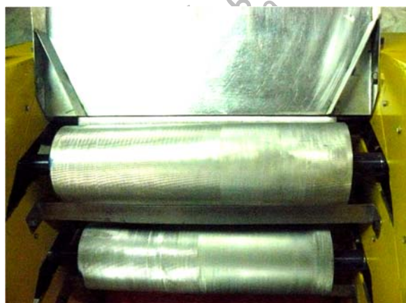
รูปที่ ก. 2 ใบปาดกล้วยกันกล้วยติดลูกกลิ้งที่ติดตั้งและปรับระยะแล้ว
