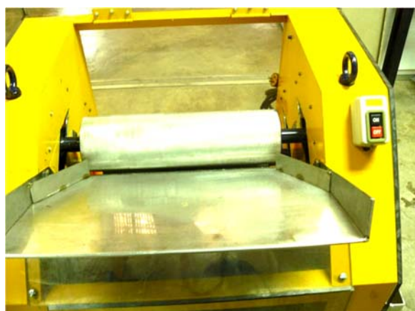
รูปที่ ก. 1 ถาดป้อนที่ติดตั้งและปรับระห่างสัมพันธ์กับลูกกลิ้ง
