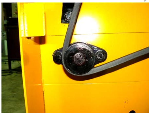
รูปที่ ก. 9 ล้อสายพานลื่นที่ถูกส่งมาจากเฟืองกลับติดทางด้านซ้ายของเครื่อง
