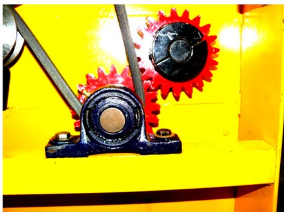
รูปที่ ก. 7 การติดตั้งเฟืองกลับทิศทางการหมุนเพื่อให้ลูกกลิ้งหมุนเข้าหากัน
