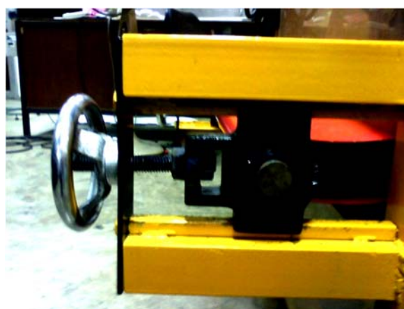
รูปที่ ก. 4 ตัวปรับความตึงที่ติดตั้งกับชุดตลับลูกปืนแบบมีตัวประกอบรางเลื่อน
