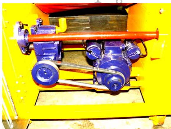
รูปที่ ก. 13 มอเตอร์ต้นกำลังและเกียร์ทด
