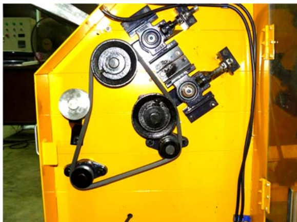
รูปที่ ก. 10 การติดตั้งชุดส่งกำลังแก่ลูกกลิ้งด้านขวาของเครื่อง
