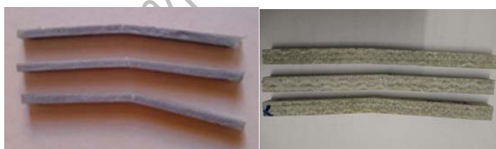
(ก) พอลิเอสเตอร์ผสมเส้นใยแก้ว (ข) อีพ็อกซีผสมเส้นใยเซรามิก
