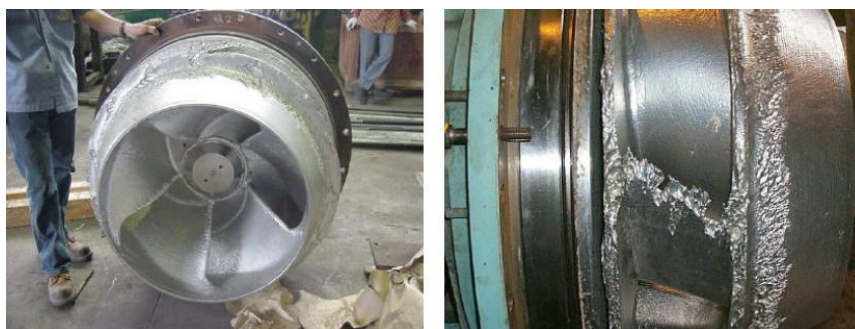
ภาพที่ 2.33 ชิ้นงานใบพัดเกิดการสึกหรอร่วมกับการกัดกร่อน (Wear Corrosion)
