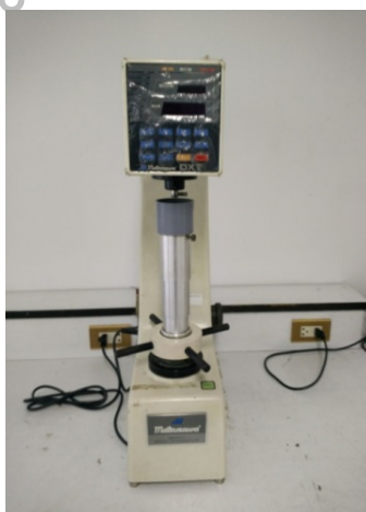
ภาพที่ 3.2 เครื่องทดสอบความแข็ง Hardness Tester (Instron-Wolppert 930/250)
