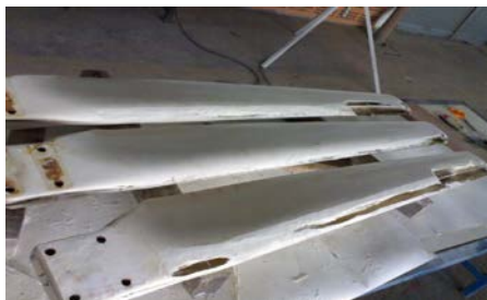
ภาพที่ 1.1 การสึกกร่อนของใบกังหันลมผลิตกระแสไฟฟ้า
