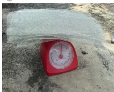
ภาพที่ 3.8 ตัดเส้นแก้วและชั่งน้ำหนัก
