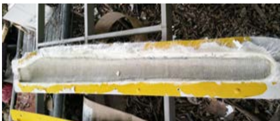
ภาพที่ 3.35 วางเส้นใยเพื่อเสริมแรง
