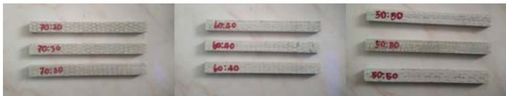
(ก) อัตราส่วน 70:30 (ข) อัตราส่วน 60:40 (ค) อัตราส่วน 50:50
