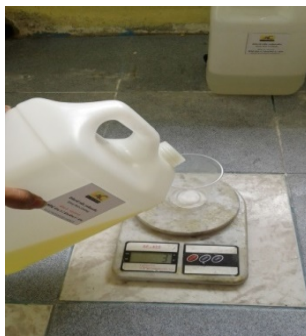
ภาพที่ 3.9 การชั่งตวงตัวทำแข็ง (Hardener) และพอลิเมอร์
