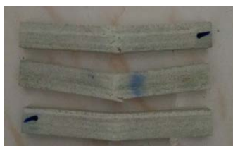
(ค) พอลิเอสเตอร์ผสมเส้นใยแก้วทับหน้า อีพ็อกซีผสมเส้นใยเซรามิก
