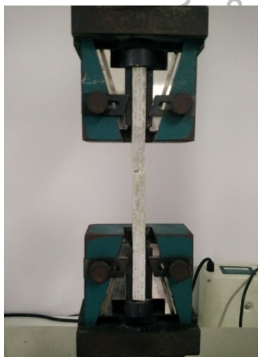
ภาพที่ 3.25 การขาดของชิ้นงานทดสอบ
