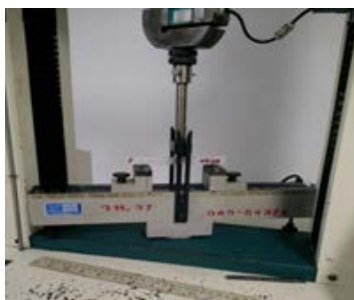
ภาพที่ 3.27 การติดตั้งตัวอย่างทดสอบเข้ากับจตุรรองรับ
