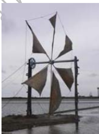
ภาพที่ 2.35 กังหันลมวิดน้ำเข้าสู่นาเกลือ
