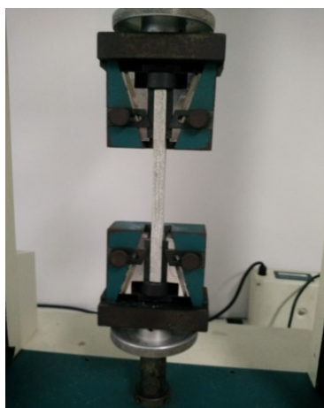
ภาพที่ 3.24 การติดตั้งชิ้นทดสอบเข้ากับเครื่องทดสอบ
