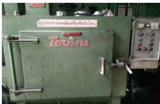
ภาพที่ 3.32 เครื่องยิงทรายทดสอบการสึกกร่อน
