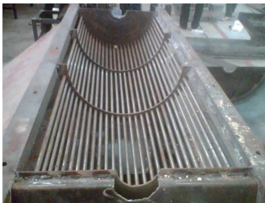
รูปที่ 3.5 นำตะแกรงมาติดตั้งเข้าที่ตัวเครื่อง
