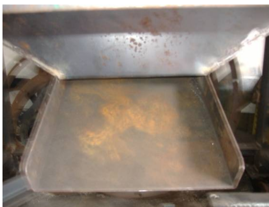
รูปที่ 3.10 ถาดรองเมล็ดที่ติดตั้งกับตัวเครื่อง
