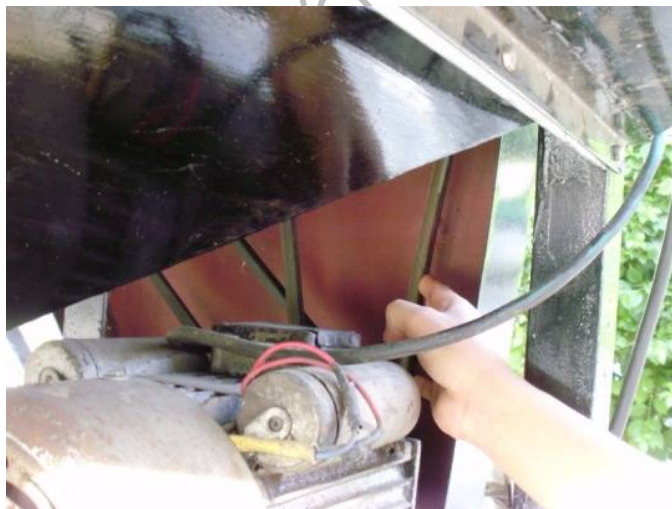
รูปที่ 4.1 ตรวจสอบสายพาน
