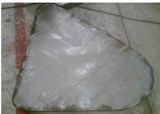
รูปที่ 3.12 ฝาครอบสายพาน
