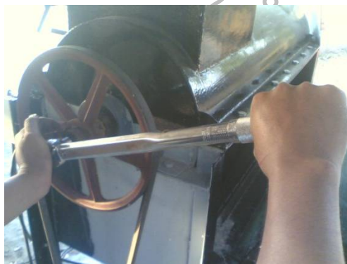
รูปที่ 3.17 หาแรงบิดเบื้องต้น
