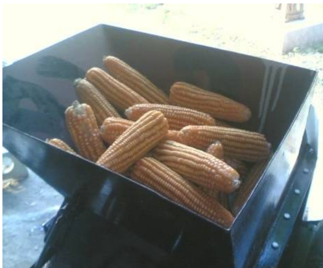
รูปที่ 4.10 เทข้าวโพดที่เตรียมไว้ลงไปปากเครื่อง
