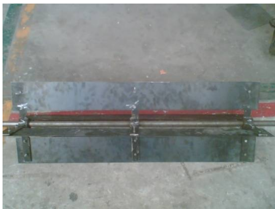
รูปที่ 3.8 นำเหล็กเพลามาเชื่อมติดกับใบพัดลม
