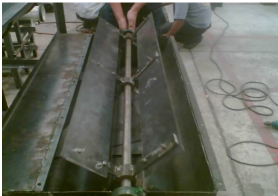
รูปที่ 3.13 ติดตั้งใบพัดลมกับแบริ่งไปที่โครงพัดลมให้เข้ากับโครง
