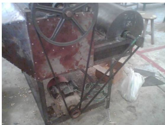
รูปที่ 3.15 ติดตั้งชุดต้นกำลังและกลไกประกอบด้วยมอเตอร์ต้นกำลัง
