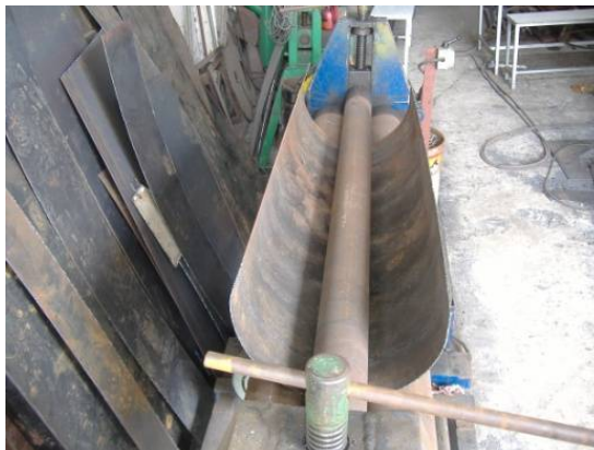
รูปที่ 3.3 การม้วนเหล็กเพื่อทำเป็นฝาครอบลูกกะเทาะ
