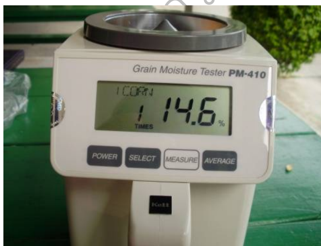
รูปที่ 4.5 อ่านค่าความชื้นของเมล็ดข้าวโพด
