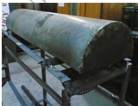
รูปที่ 3.4 นำฝาครอบลูกกะเทาะมาติดตั้งที่ตัวเครื่อง
