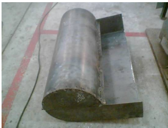
รูปที่ 3.7 นำเหล็กแผ่นมาม้วนขึ้นรูปให้เป็นโครงพัดลม
