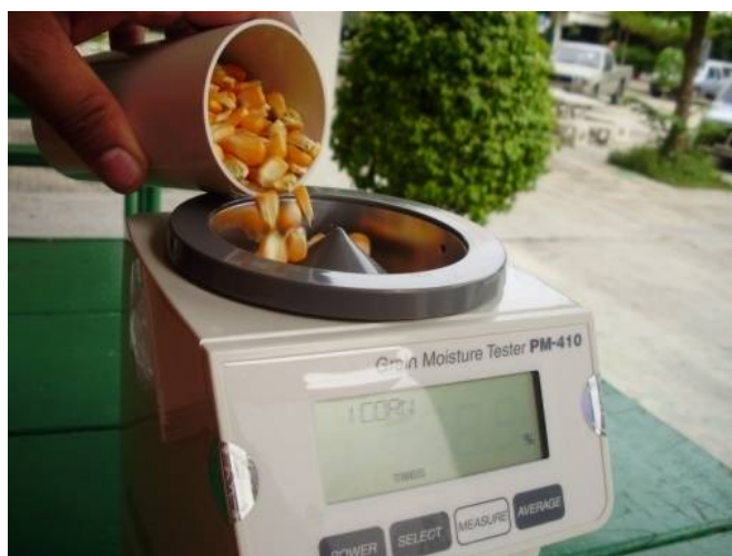
รูปที่ 4.4 เทเมล็ดข้าวโพดลงในเครื่องวัดความชื้น
