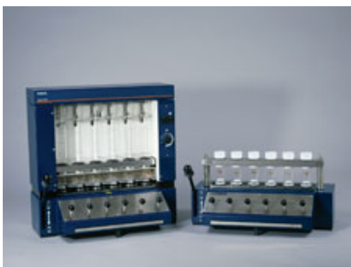
ภาพผนวกที่ 7 เครื่องวิเคราะห์เยื่อใย (Total fiber)
