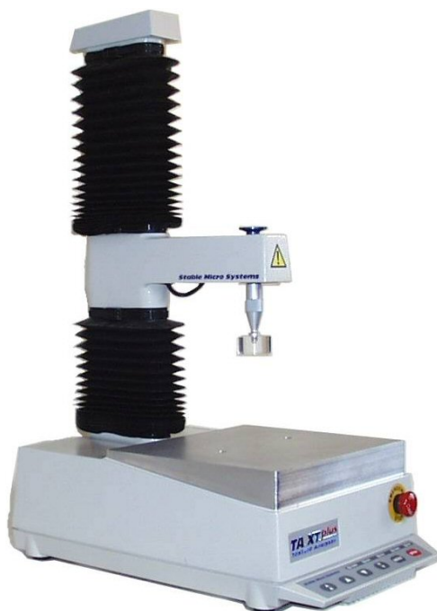
ภาพผนวกที่ 3 เครื่องวัดเนื้อสัมผัส Texture Analyzer
