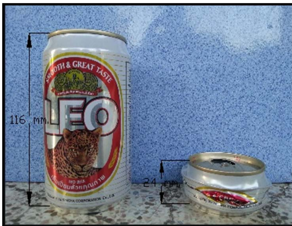
รูปที่ 4.3 ผลการทดลองการยุบตัวของกระป๋องอลูมิเนียมขนาด 330 มิลลิลิตร
