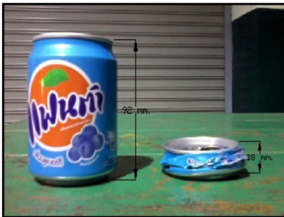
รูปที่ 4.2 ผลการทดลองการยุบตัวของกระป๋องอลูมิเนียมขนาด 240 มิลลิลิตร
