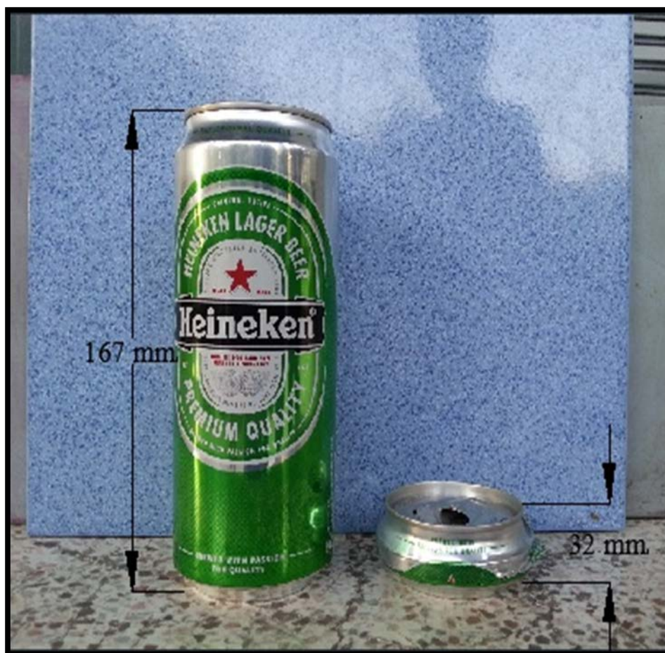
รูปที่ 4.4 ผลการทดลองการยุบตัวของกระป๋องอลูมิเนียมขนาด 500 มิลลิลิตร
