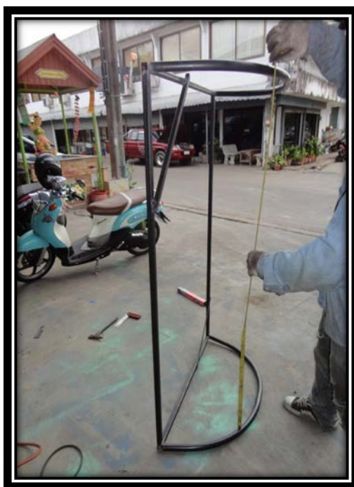
รูปที่ 3.9 ลักษณะและโครงสร้างของเครื่องอัดกระป๋องเครื่องดื่มนม
