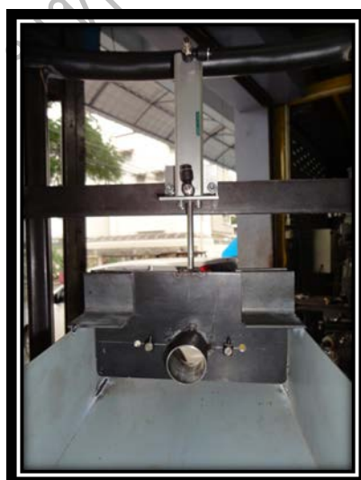
รูปที่ 3.10 ช่องใส่กระป๋อง ประตู เปิด - ปิด และ ชุดลำเลียงกระป๋องเครื่องดื่มนม
