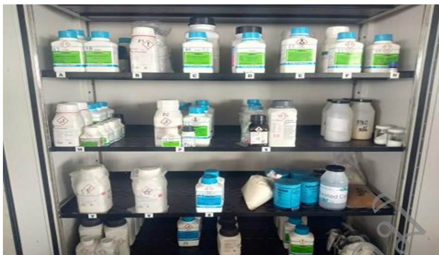
ภาพที่ 4.2 การจัดตู้สารเคมีและติดฉลากแสดงอันตราย
