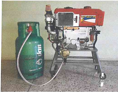
รูปที่ 3.16 เครื่องยนต์ที่ดัดแปลงและติดตั้งอุปกรณ์ที่เสร็จสมบูรณ์
