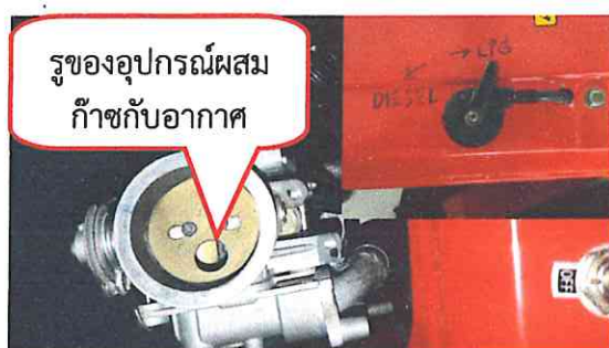
(ก) อุปกรณ์ผสมก๊าซกับอากาศ เมื่อใช้ก๊าซแอลพีจีเป็นเชื้อเพลิง
