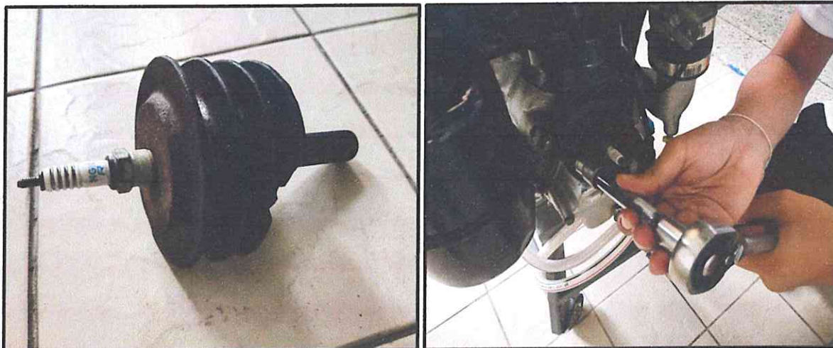
รูปที่ จ.5 ติดตั้งห้องเผาไหม้เสริมเข้ากับฐานห้องเผาไหม้เสริม
