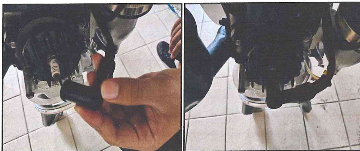
รูปที่ จ.6 ต่อปลั๊กหัวเทียนเข้ากับหัวเทียน
