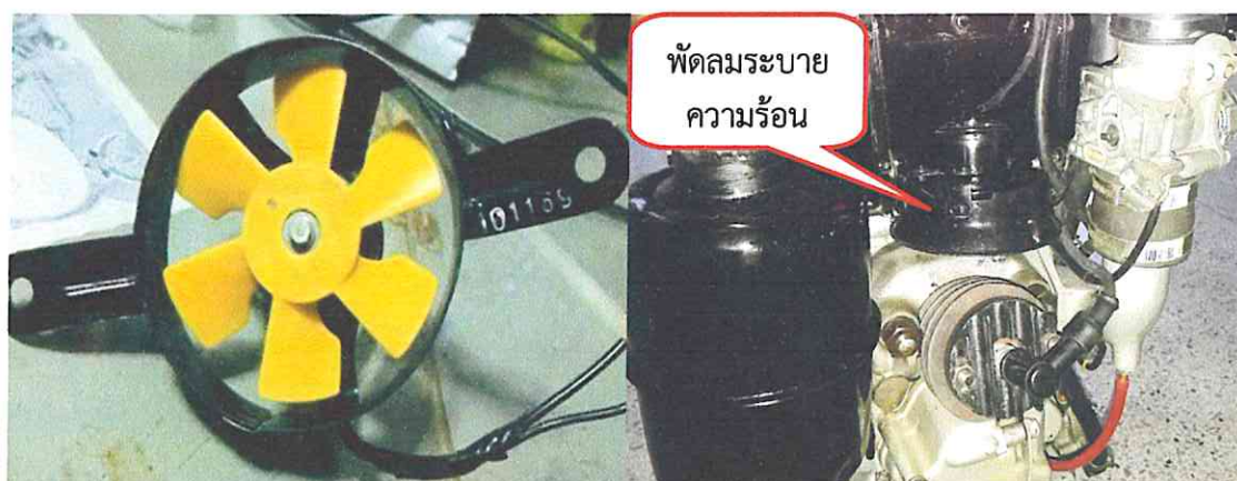
รูปที่ 3.15 พัดลมระบายความร้อน
