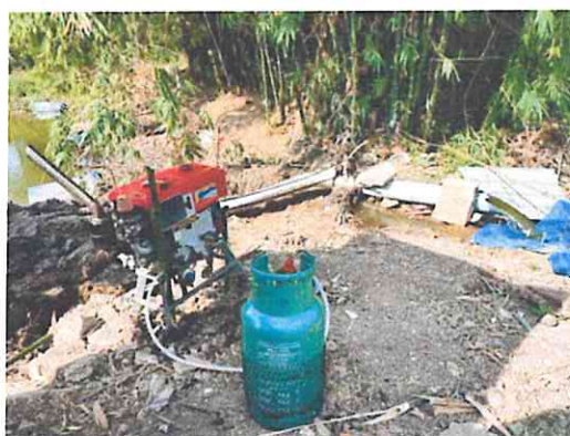
รูปที่ 4.5 การทำงานแบบเครื่องยนต์แก๊สโซลีนที่ใช้ก๊าซแอลพีจีเป็นเชื้อเพลิง
