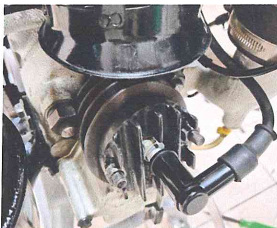
รูปที่ 3.14 ห้องเผาไหม้เสริมติดตั้งเข้าแทนที่ตำแหน่งของหัวฉีดน้ำมันดีเซลเดิม
