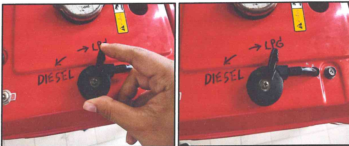
รูปที่ จ.7 ปรับคันโยกให้อุปกรณ์ผสมก๊าซกับอากาศอยู่ที่ตำแหน่ง LPG
