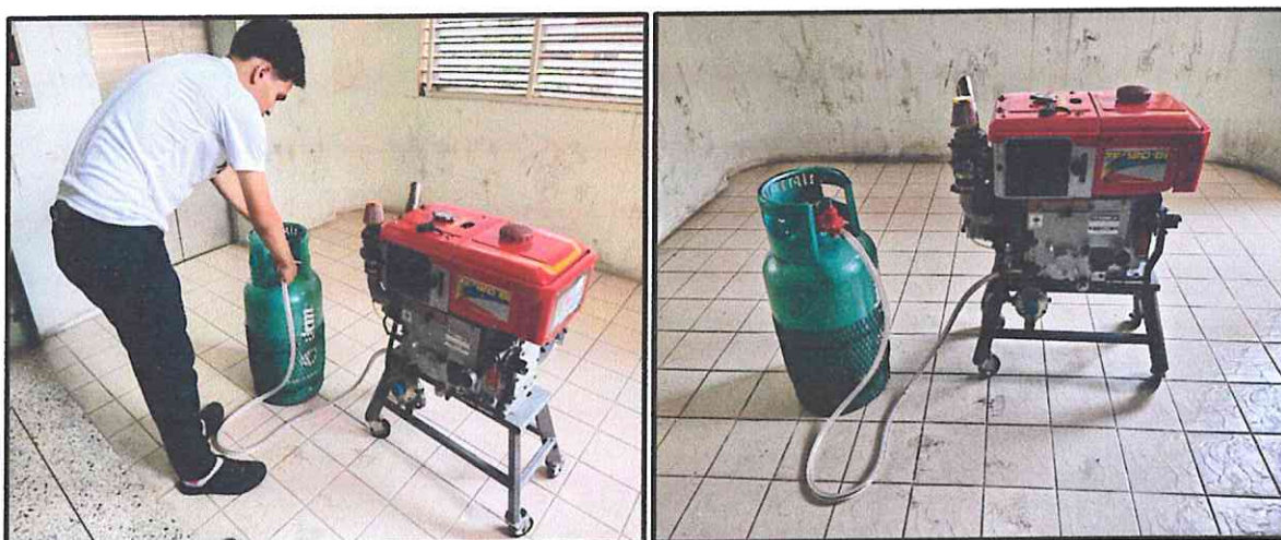
รูปที่ จ.8 ติดตั้งเรกกูเลเตอร์ (หัววาล์วก๊าซ) เข้ากับถังก๊าซ
