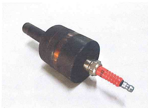
รูปที่ 3.13 ห้องเผาไหม้เสริมของการวิจัยครั้งที่ผ่านมา
