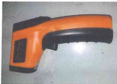
รูปที่ 4.1 อินฟราเรดเทอร์โมมิเตอร์ รุ่น Benetech GM320
