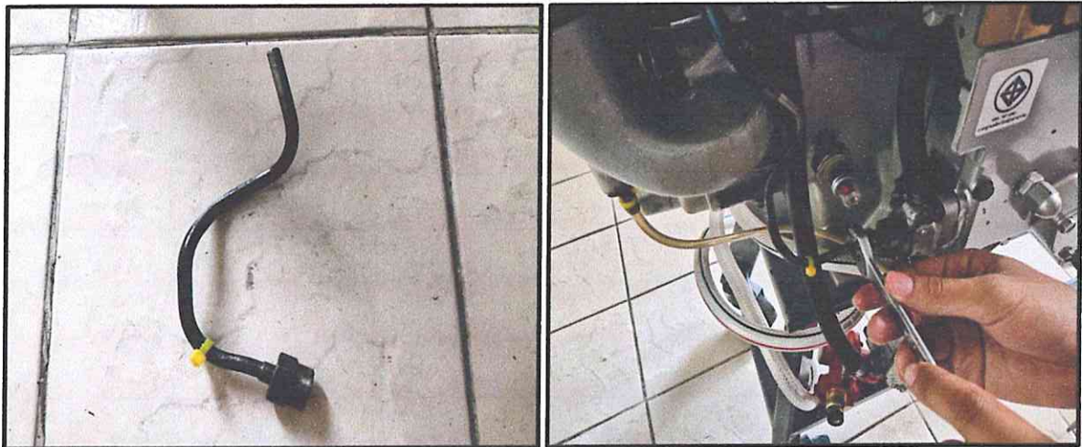
รูปที่ จ.2 ต่อท่อน้ำมันไหลกลับจากปั๊มฉีดเชื้อเพลิงไปยังถังน้ำมันเชื้อเพลิง
