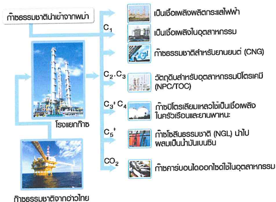
รูปที่ 2.5 กระบวนการแยกก๊าซ [7]
