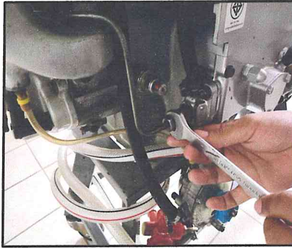
รูปที่ จ.1 ถอดท่อน้ำมันเชื้อเพลิงออกจากปั๊มฉีดเชื้อเพลิง
