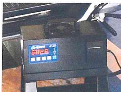
รูปที่ 4.3 เครื่องวัดควันทำระบบความทึบแสง รุ่น Koeng OP-201T
