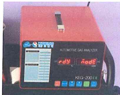
รูปที่ 4.2 เครื่องวิเคราะห์ก๊าซไอเสีย รุ่น Koeng KEG-200
