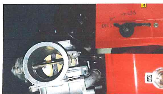
(ข) อุปกรณ์ผสมก๊าซกับอากาศเปิดกว้างสุดเมื่อใช้งานในแบบเครื่องยนต์ดีเซล
