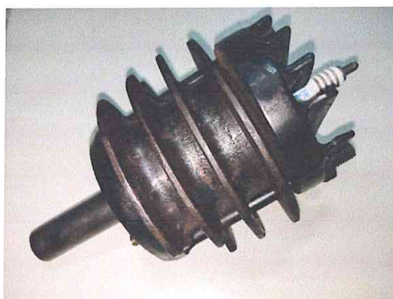
รูปที่ 3.12 ห้องเผาไหม้เสริมติดตั้งครีระบายความร้อน
