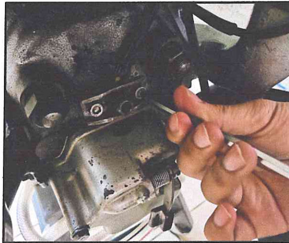
รูปที่ จ.3 ถอดหัวฉีดน้ำมันดีเซลออกจากฝาสูบ
