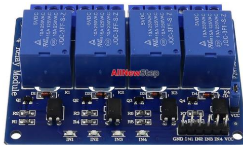
ภาพที่ 3.8 โมดูลรีเลย์ (ที่มา: https://www.allnewstep.com )
